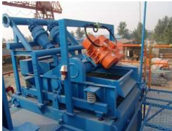
Fotografía 2. 35 Desarenador Utilizado en Equipos Tipo de Perforación
