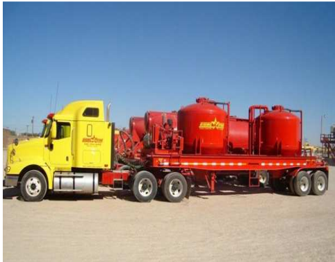
Fotografía 2. 36 Equipo de cementación.
