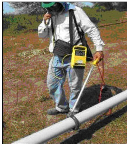
**Fotografía 2-76:** Inspección del revestimiento de la tubería, detección de puntos de falla.
