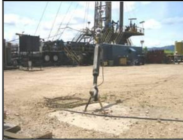
**Fotografía 2-61:** Anclajes del equipo de perforación.
