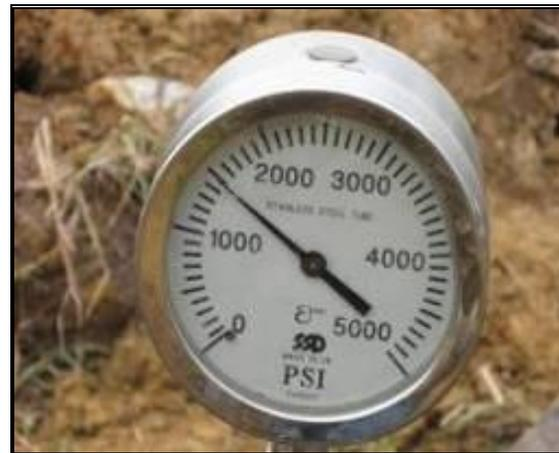
**Fotografía 2-80:** Prueba hidrostática.
