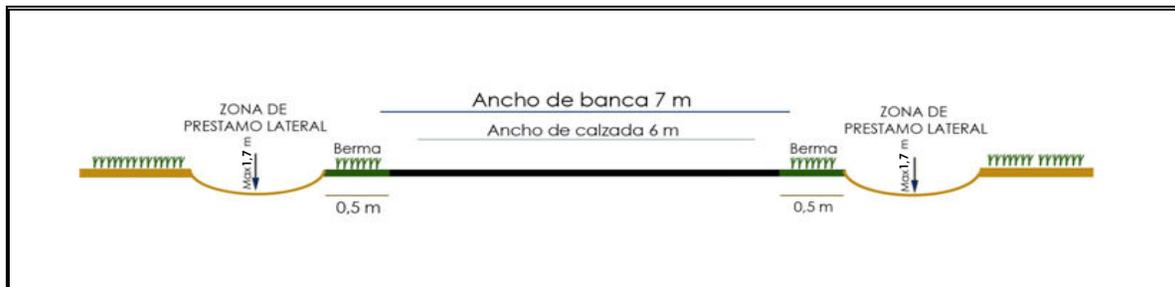
**Figura 2-5:** Diagrama general de vías de acceso a construir.
